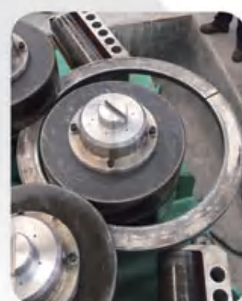
型材弯曲机技术参数 profile bending machine
